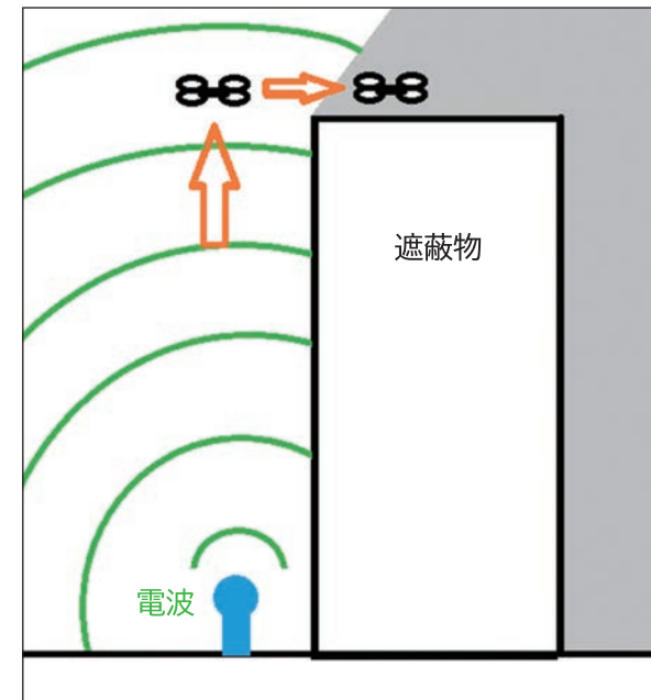
ドローンに届く電波の範囲の模式図①
