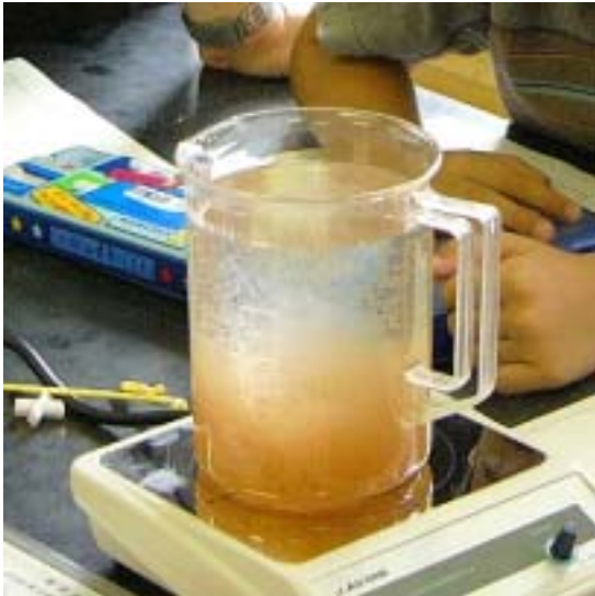
写真7 フロック形成と沈降状況
